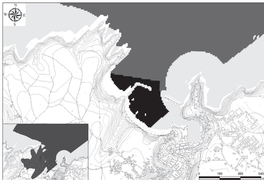
5. Estudio, a partir de los ángulos de tiro, del área cubierta por las piezas artilleras de la batería de La Atalaya. En negro el área correspondiente a las troneras conservadas y en gris la zona atribuible a las troneras obtenidas mediante georeferenciación.
