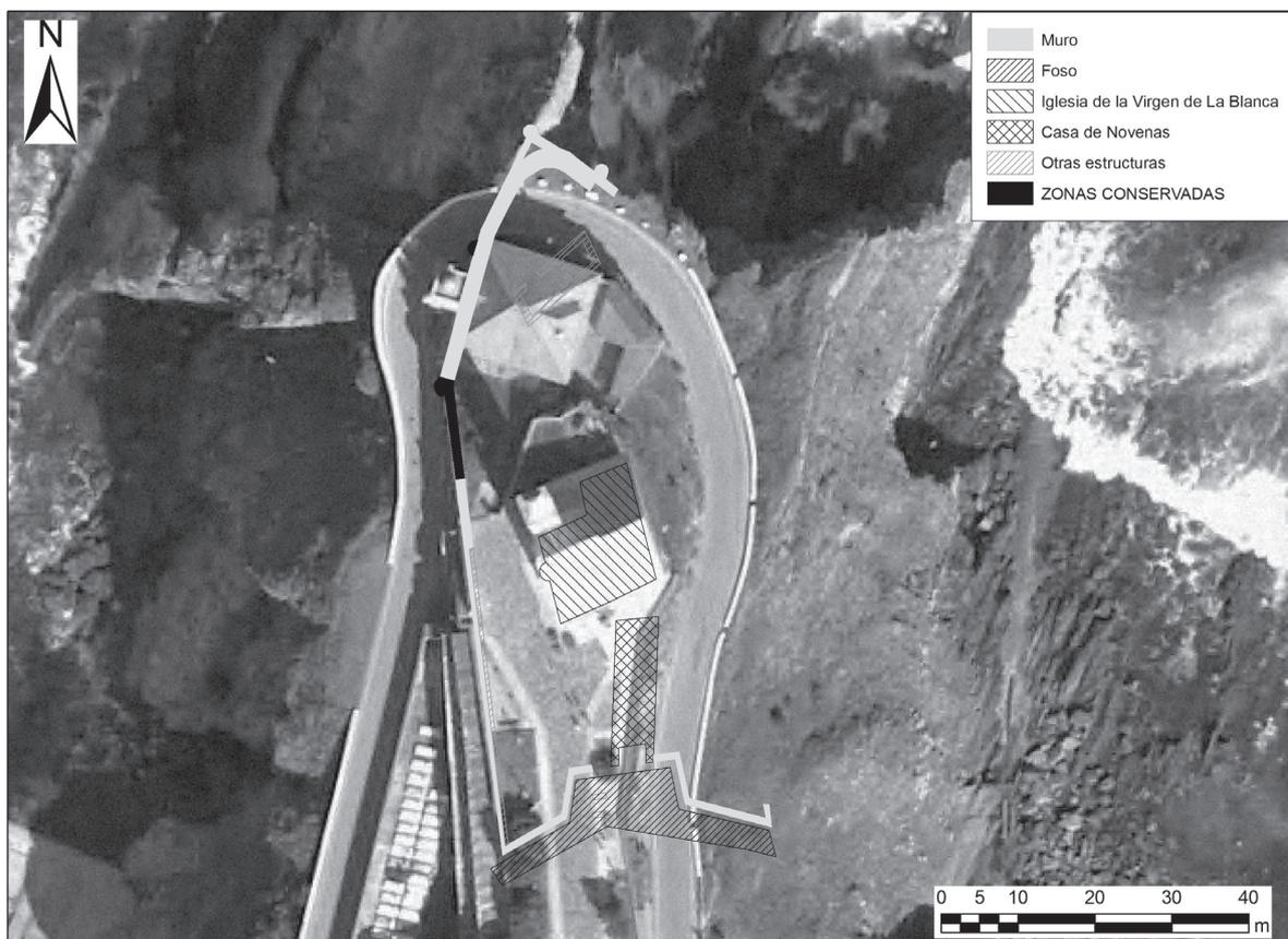
6. Superposición de las estructuras de la Batería de La Atalaya, obtenidas mediante georreferenciación de cartografías históricas, y la ortofotografía aérea actual.
