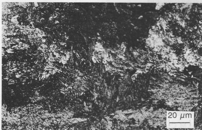
Fig. 1.–Zona de fusión de la soldadura aluminotérmica de un carril 1100 aleado con 0,44 Cr-0,12 Mo. Estructura mixta de perlita y bainita. Precalentamiento normal.
