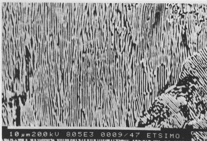
Fig. 2.–Carril calidad 900A tratado térmicamente. Espaciado entre láminas de la perlita inferior a 0,1 μm.
