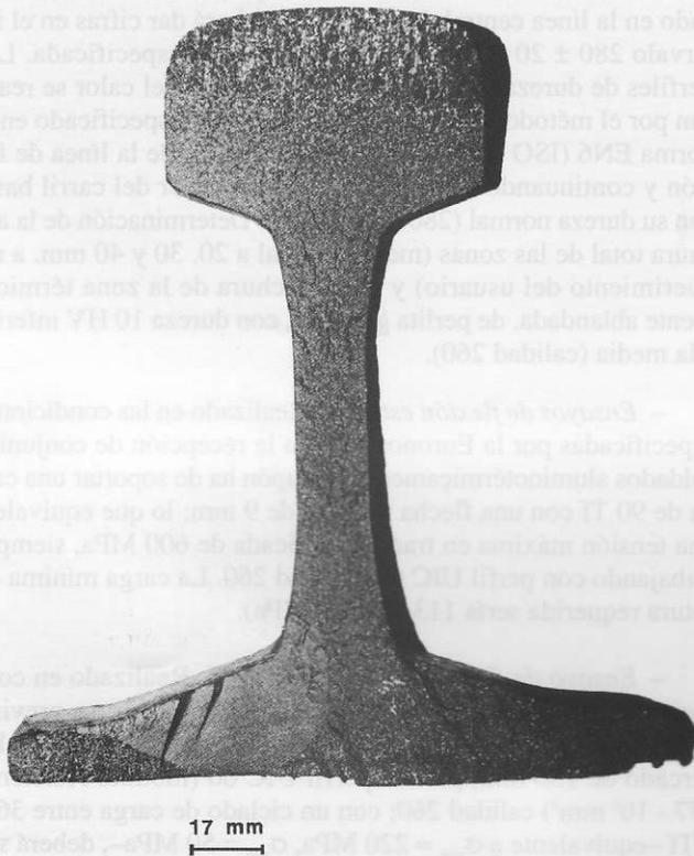
Fig. 1.–Rotura por fatiga de un carril soldado aluminotérmicamente. Superficie de fractura.
