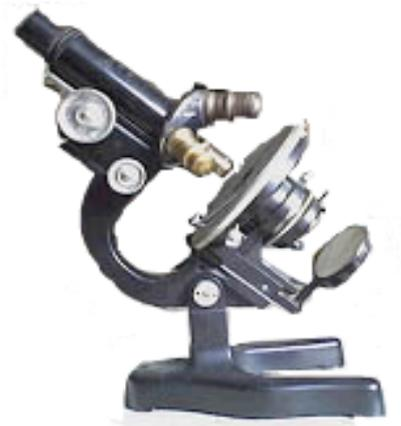
**Para dotarlos de mayor comodidad en la observación se intercaló un prisma entre el objetivo y el ocular, que permite una observación angular con la platina horizontal.**
