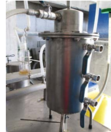
Reactor anaerobio de flujo ascendente
