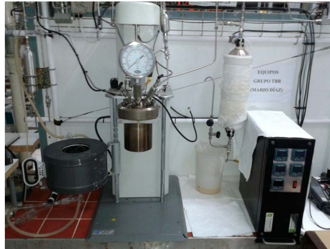
Reactor de hidrólisis térmica
