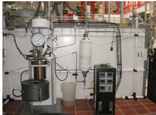
Reactor de hidrólisis térmica
