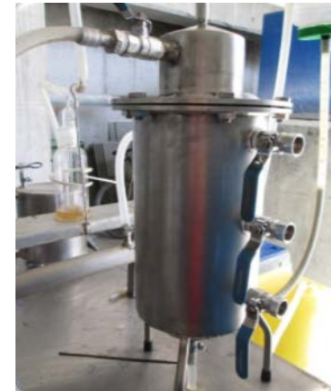
Reactor anaerobio de flujo ascendente
