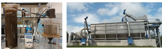
Figura 42. Lodos activos en laboratorio, y planta integrada modular
