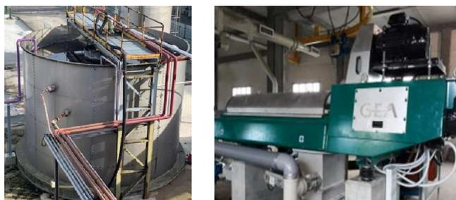
Figura 39. Tanque de espesamiento, y centrífuga horizontal
