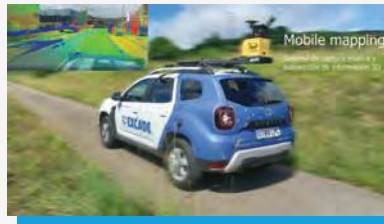
Mobile Mapping. Tecnología LiDAR para digitalización de la realidad
