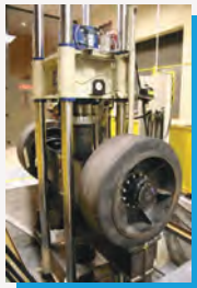
Ensayo a fatiga de un bogie de rodadura
