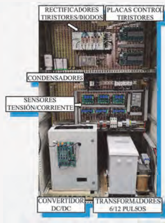
Armarío con diferentes topologías AC/DC y DC/DC
