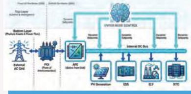
Arquitectura de un sistema híbrido AC/DC de Generación de Hidrógeno Verde con generación local, almacenamiento de energía y cargas variables
