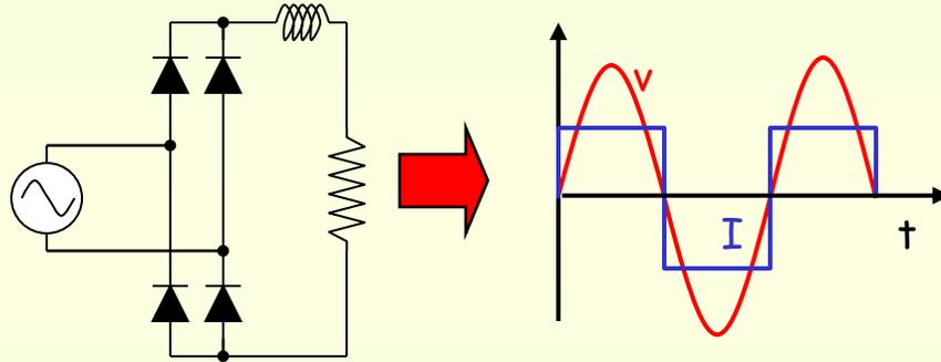
LA ETAPA DE ENTRADA DEL BALASTO ELECTRÓNICO TIENE UN EFECTO IMPORTANTE EN LA FORMA DE LA CORRIENTE
