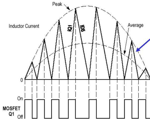
El convertidor opera en la frontera entre DCM y CCM.
