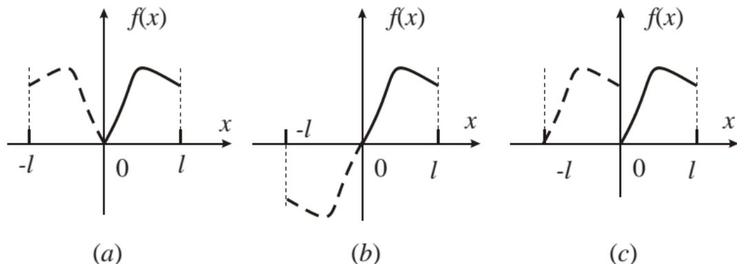
Figura: (a) Extensión par. (b) Extensión impar. (c) Repetición.
