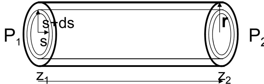
**Objetivo:** cantidad de volumen de fluido que circula por la conducción por unidad de tiempo en función de la diferencia de presión aplicada entre los extremos de la conducción (caudal)
