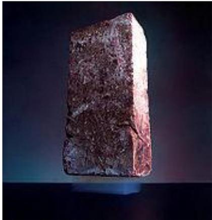
Un ladrillo de 2,5 kg soportado por 2 g de un **aerogel**
