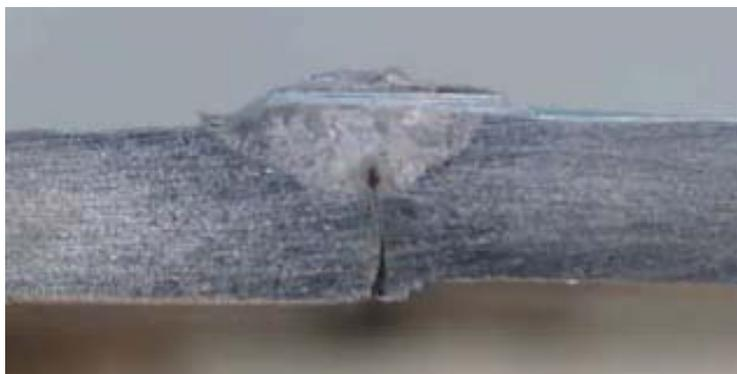
Figura 13a y fotografía 13b: Soldadura a tope.
