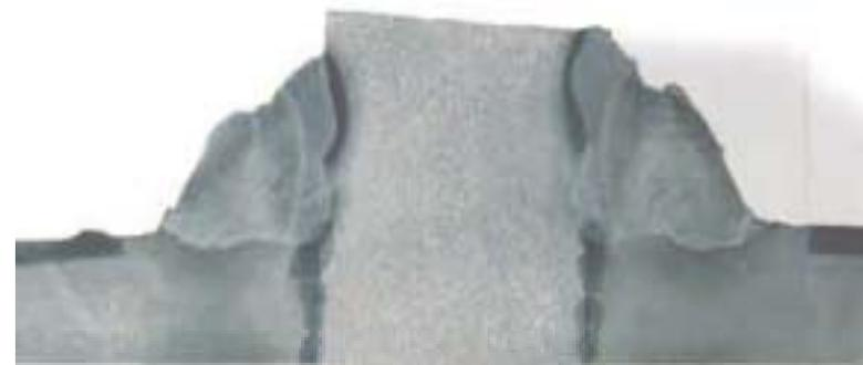
Figura 13c y fotografía 13d: Soldadura en ángulo.
