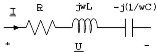
Figura 4.1: Circuito resonante serie
