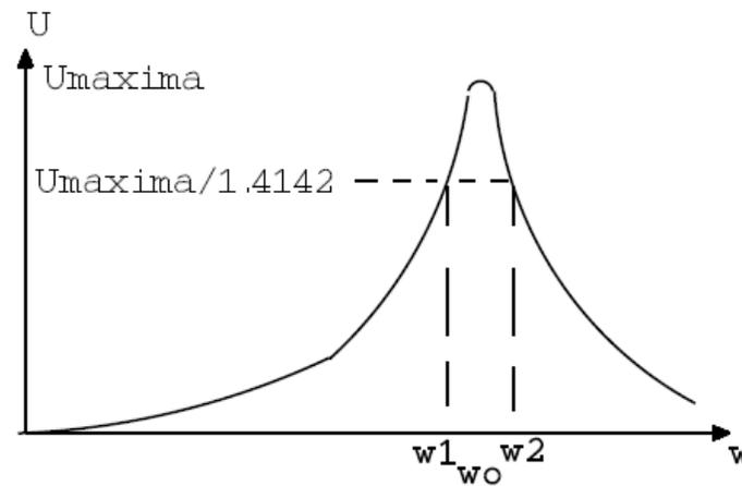
Figura 4.4: Respuesta en frecuencia circuito paralelo
