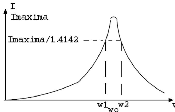
Figura 4.2: Respuesta en frecuencia circuito serie
