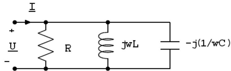
Figure 4.3: Circuito resonante paralelo
