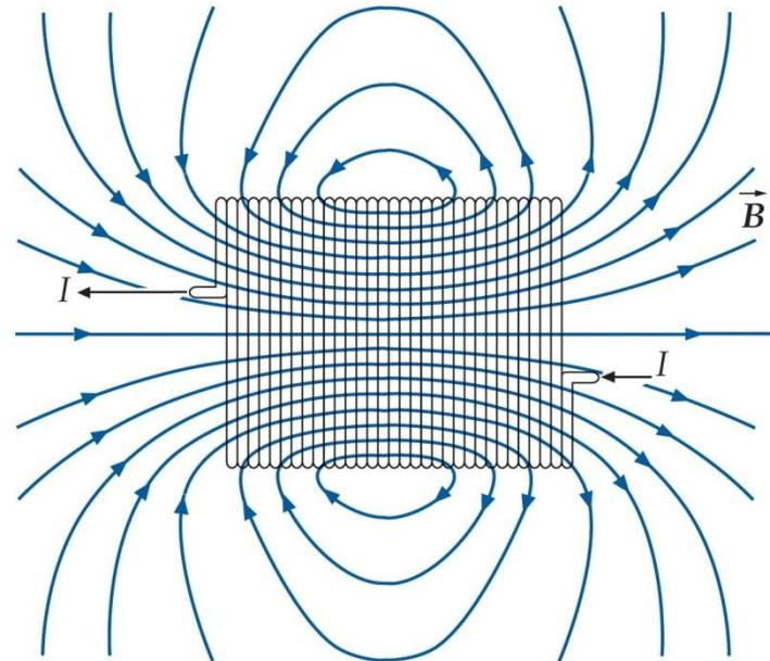
Líneas del campo magnético producido por una corriente eléctrica circulando a través de un carrete
