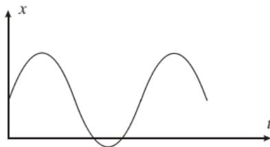
Figura: Vibraciones libres sin amortiguamiento.
