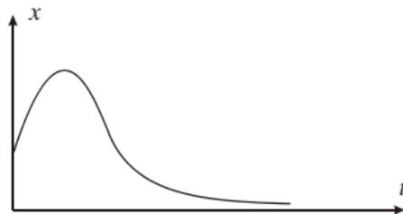
**Figura:** Movimiento críticamente amortiguado.
