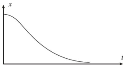
Figura: Movimiento sobreamortiguado.
