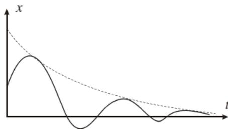
**Figura:** Movimiento subamortiguado.
