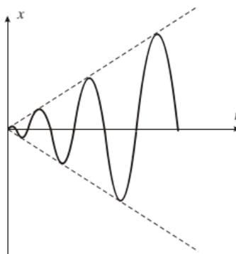
Figura: Sistema en resonancia.
