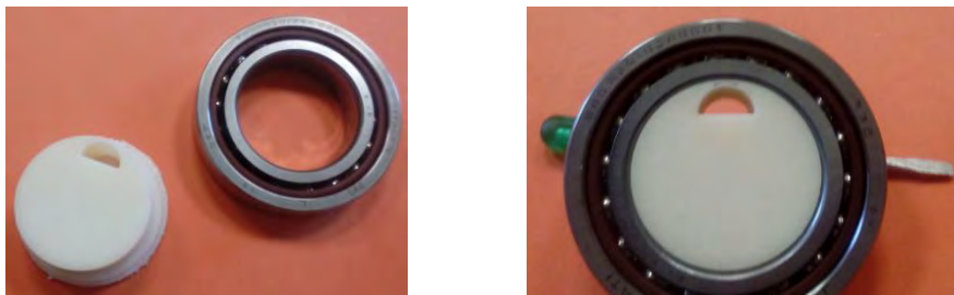
Figura 3 Diseño de Leva basada en la fabricación aditiva
