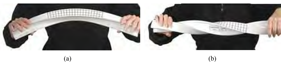
Figura 1 Viga extra-flexible Pasco mostrando pandeo lateral (a) y torsión de alabeo (b)
