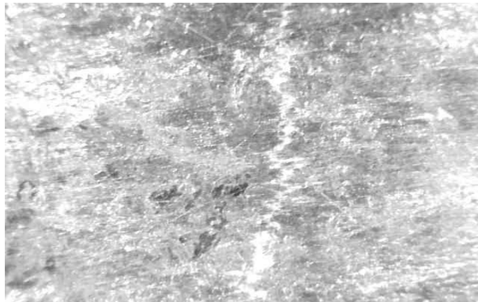
Figura 4 Imagen de Microscopía óptica (x50A) de la superficie inferior (sometida a tracción) de una pieza de resina epoxi reforzada con fibra de carbono tras ensayo de flexión.
