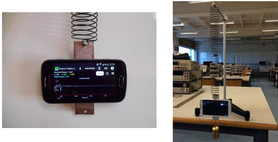
Figura 3 Colocación del teléfono en el muelle
