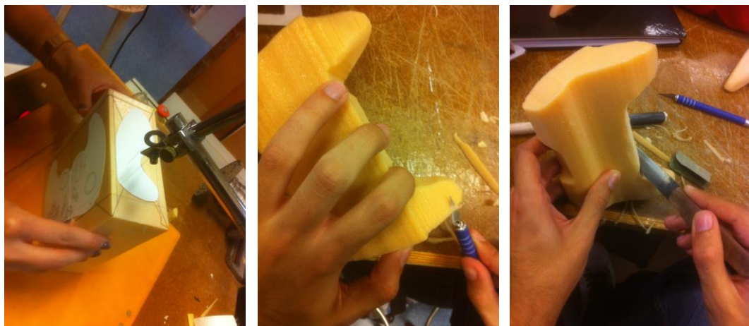
Figura 4. Proceso de corte y desbaste para la obtención del primer modelo en espuma
