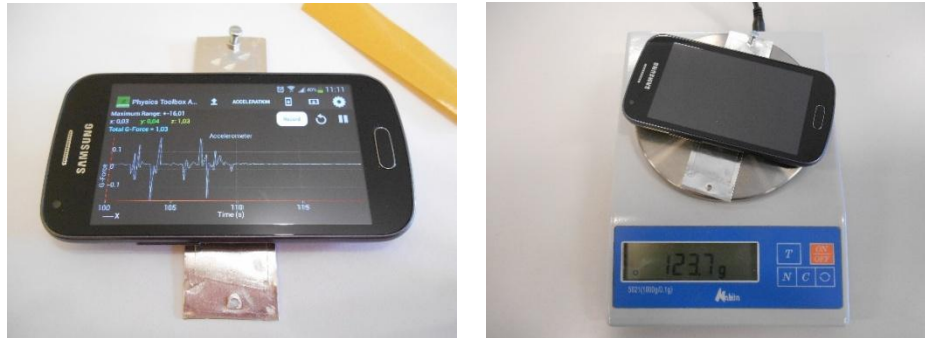
Figura 2 Colocación del teléfono sobre la chapa, y medida de su masa
