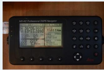
Os aparelhos DGPS apresentam posições geográficas mais precisas do que os aparelhos normais de GPS, uma vez que recebem informação extra de um GPS em terra, permitindo a correção do erro existente no GPS do navio.
