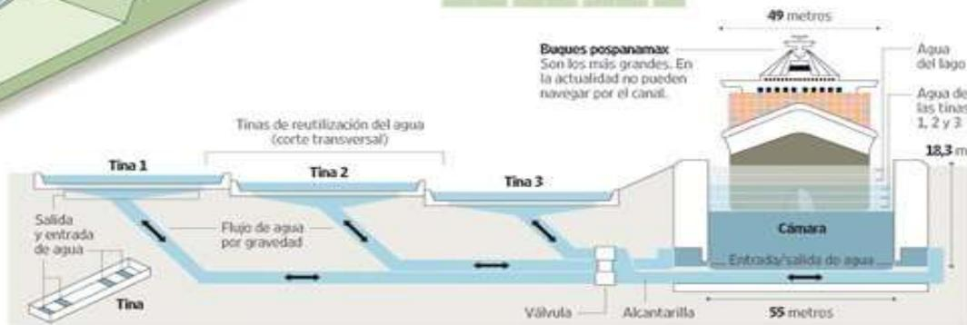
El canal actual tiene dos carriles para la circulación en los dos sentidos. Con su sistema de esclusas se pierde la totalidad del agua de las cámaras.
