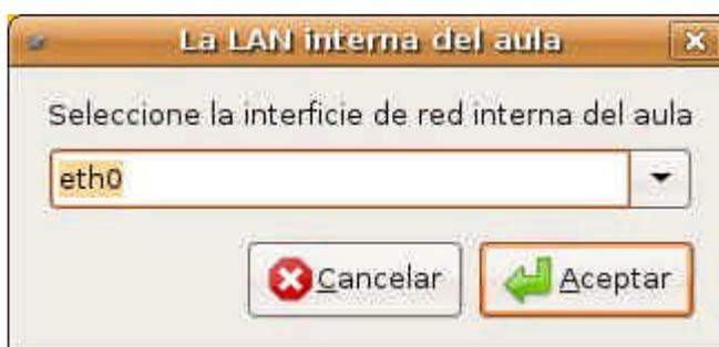
Mantener eth0 como interfaz interna y Aceptar. En la ventana siguiente se configuran las propiedades de dicha interfaz. En concreto esta interfaz eth0 debe tener siempre la IP fija **10.0.2.254/24**.
