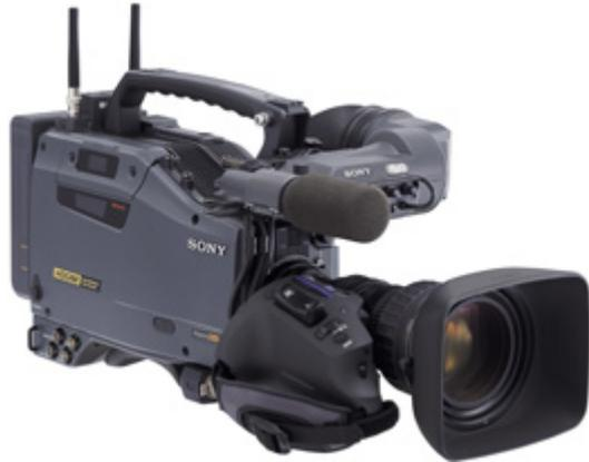
**HDW-730S** 3 sensores CCD IT de 2,2 millones de pixels y procesado digital de señal avanzado (ADSP). El camcorder es conmutable entre 1080/50i y 1080/59,94i, (\$37,500.00 U.S.)
