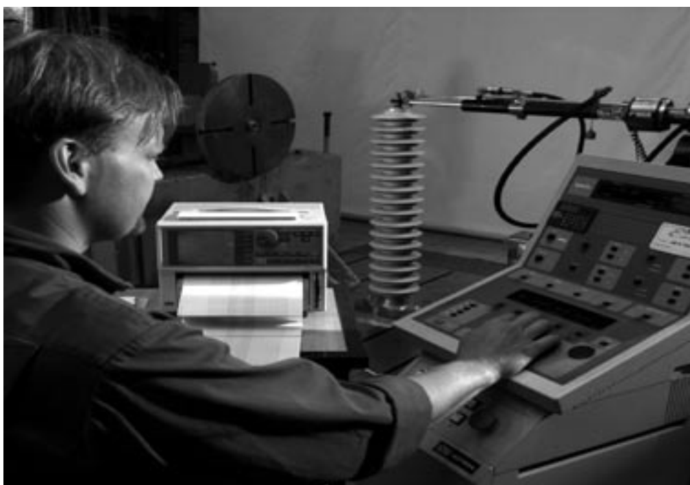
Prueba mecánica de descargadores con revestimiento de silicona PEXLIM P.
