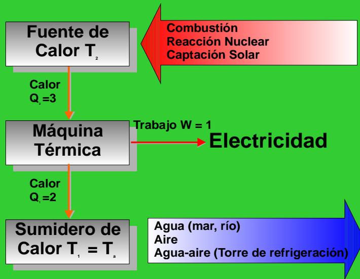
Esquema de central termoeléctrica
