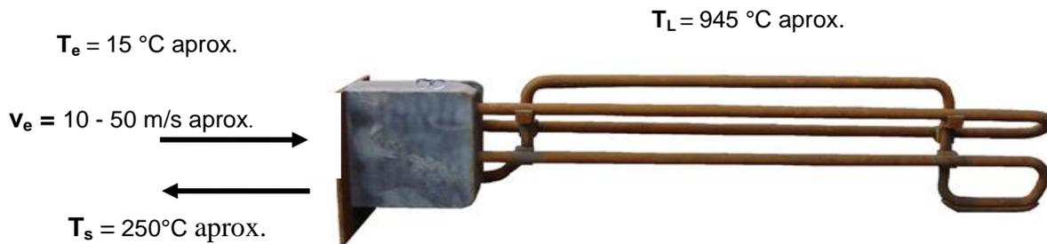
**Figura 3.12** Haz de refrigeración del HLFB.  $T_e$ = temperatura de entrada del agua,  $T_s$ =temperatura salida del agua,  $v_e$  = velocidad de entrada del agua,  $T_L$  = temperatura del lecho fluido.
