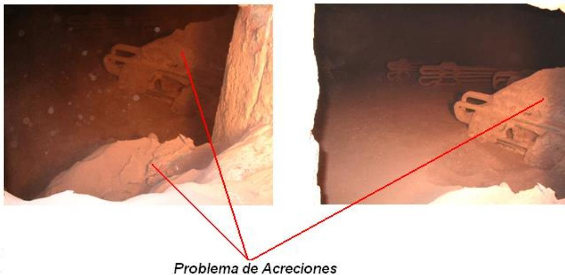
**Figura 2.14.** Acreciones formadas sobre haces de refrigeración en el reactor de lecho fluidizado<sup>[13]</sup>.
