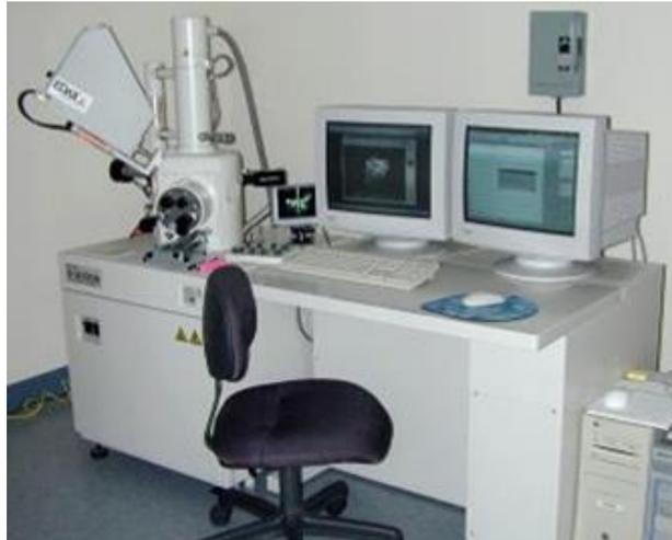
**Figura 3.5** Microscopio electrónico de barrido, laboratorios UNIOVI.
